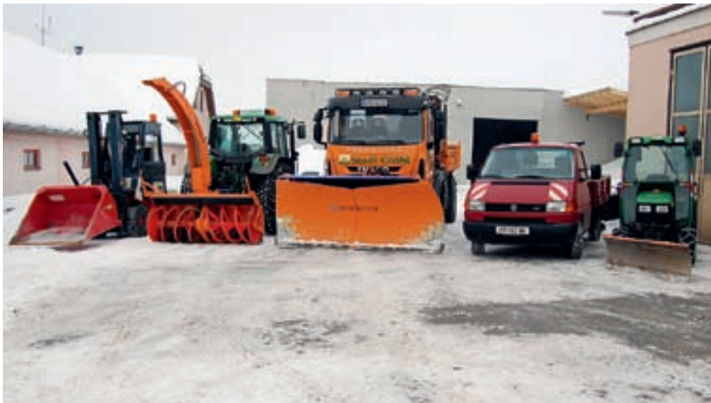
Die aktuellen Winterdienstgeräte der Gemeinde Gföhl: Stapler mit Schaufel, Traktor mit Schneefräse/Streugerät und Schneepflug, Lkw mit Schneepflug und Streugerät, VW-Pritsche mit Salzstreuer und Kleintraktor mit Schneepflug und Streugerät.
